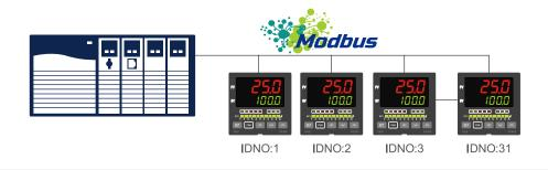
相容Modbus RTU通訊協議,可與市面上所有人機界面、PLC和SCADA軟體快速建立連結。
